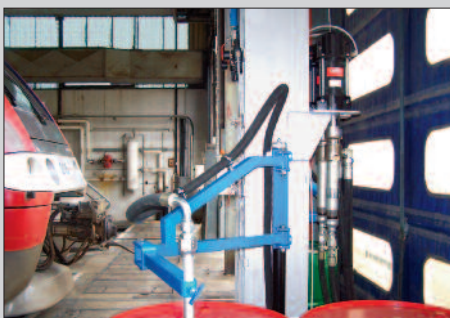
Bombas de pistón de 2 bolas, de relación 9:1, usadas en un proceso de lubricación personalizada.
