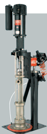
Elevadores de columna única Elevador de columna única equipado con bomba, plato seguidor y controles para extrusión de media a alta viscosidad.
