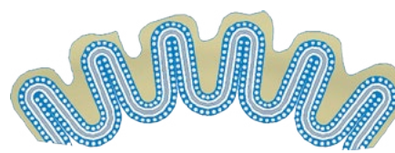
Cartuccia con elevato deposito
